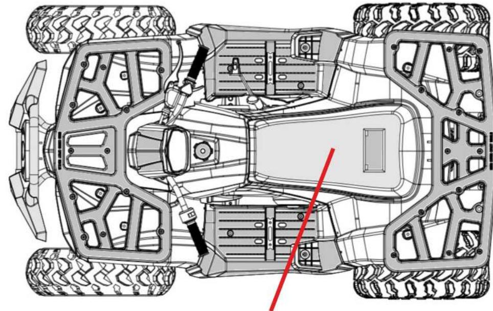
Расположение главного предохранителя
