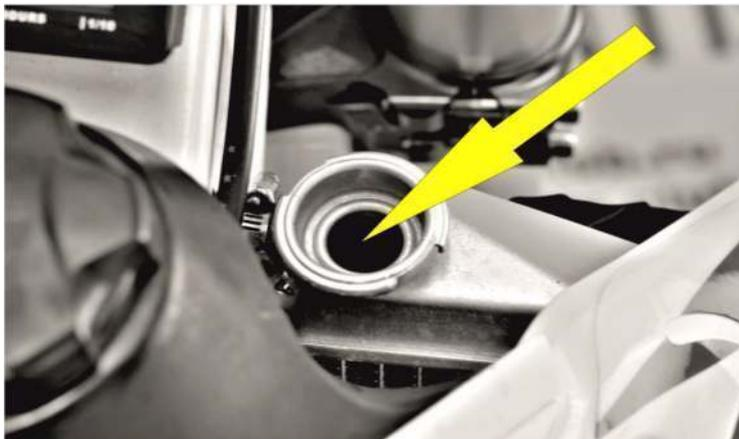
Система охлаждения должна быть очищена после слива охлаждающей жидкости или после добавления охлаждающей жидкости объемом более 0,25 л.
