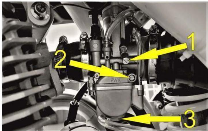
Холостой ход регулируется регулировочным винтом [1] и винтом качества смеси [2].
