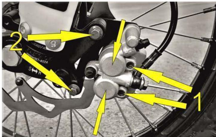
Тормозные колодки должны встать в свои пазы, чтобы между ними прошел тормозной диск. Установите тормозной суппорт вместе с кронштейном на свое место. Затяните болты [2] с моментом 25 Нм + Loctite 243.
