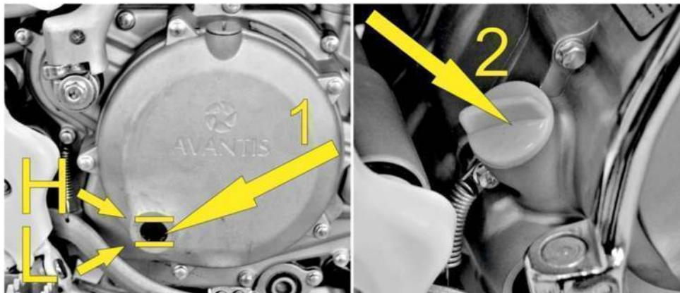
На теплом двигателе; уровень моторного масла должен быть между отметками [L] и [H] в смотровом окне или на масляном щупе.
