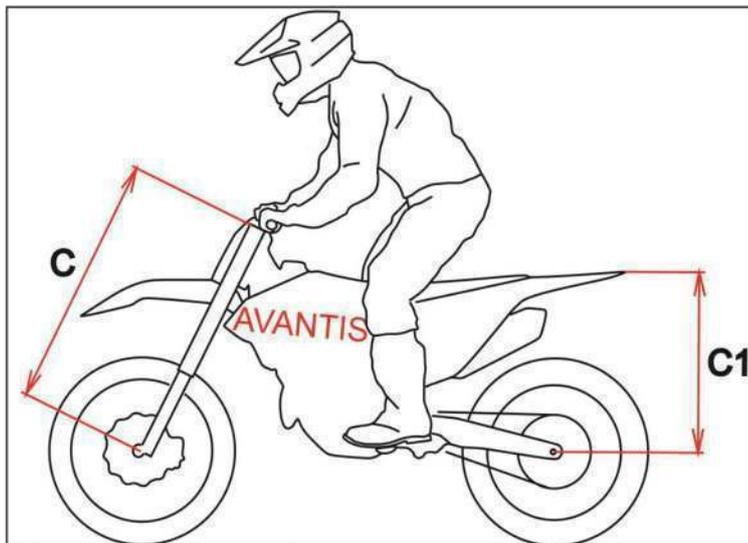
**Значение ходового проседания должно быть в диапазоне 80 мм спереди и 100 мм сзади +/-5 мм.**
