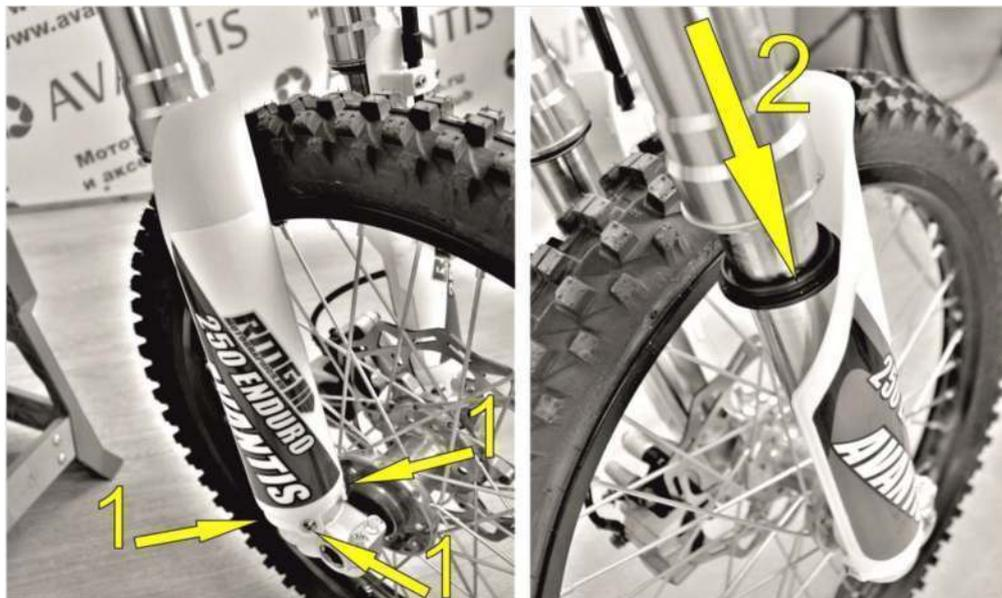
Внимательно очистите пыльники, смазав их машинным маслом, после чего вручную протолкните их обратно в наружные трубы. Установите пластиковую защиту и затяните болты [1] с моментом до 10 Нм.
