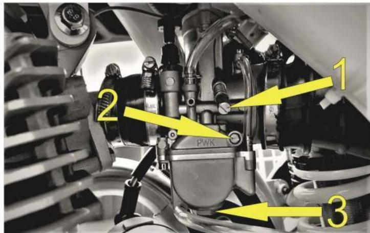
**Для корректной регулировки холостого хода, выполните следующие действия:**
