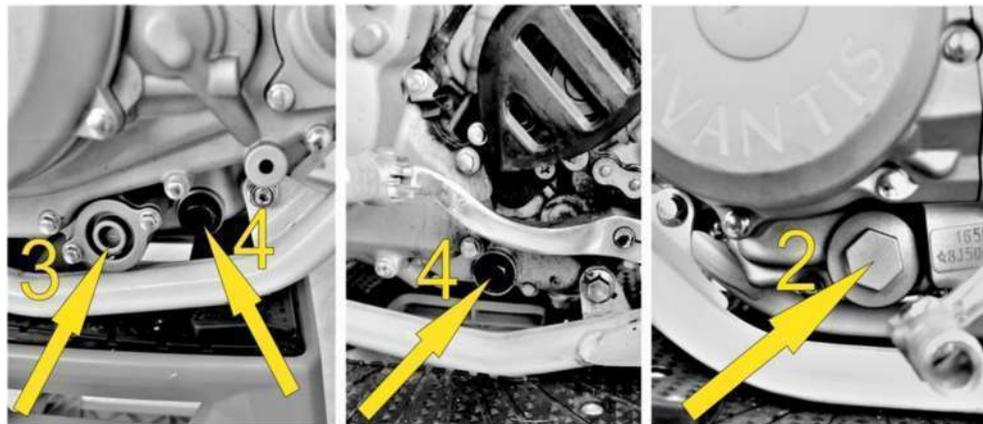
– Сетчатые масляные фильтры (**грубой очистки**) можно установить повторно, если они поддаются тщательной очистке и сушке; от частиц фрикционных дисков сцепления и от частиц металла.
