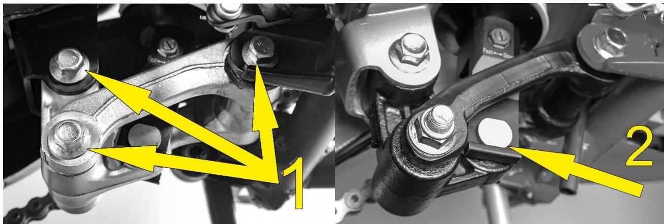
Степень затяжки болтов прогрессии [1] (52 Нм), кроме болта [2] крепления к нижнему уху амортизатора (32 Нм).
