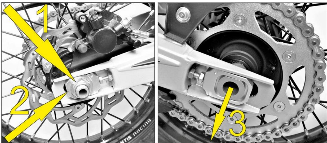
Если ось демонтирована, тщательно очистите резьбу оси [3] колеса и гайку [1].
