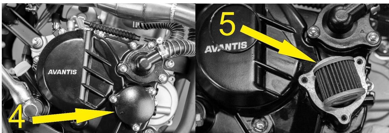
На двигателе ZS CBS300/174MN-3 с правой стороны под крышкой картера [4], установлен фильтр тонкой очистки [5], необходимо заменить его на новый при каждой замене масла.
