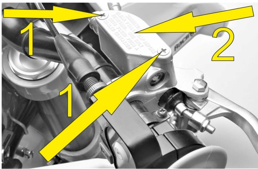
Установите тормозной цилиндр в горизонтальное положение и заполните бачок чистой тормозной жидкостью (DOT 4) до уровня (5 мм) ниже обода.
