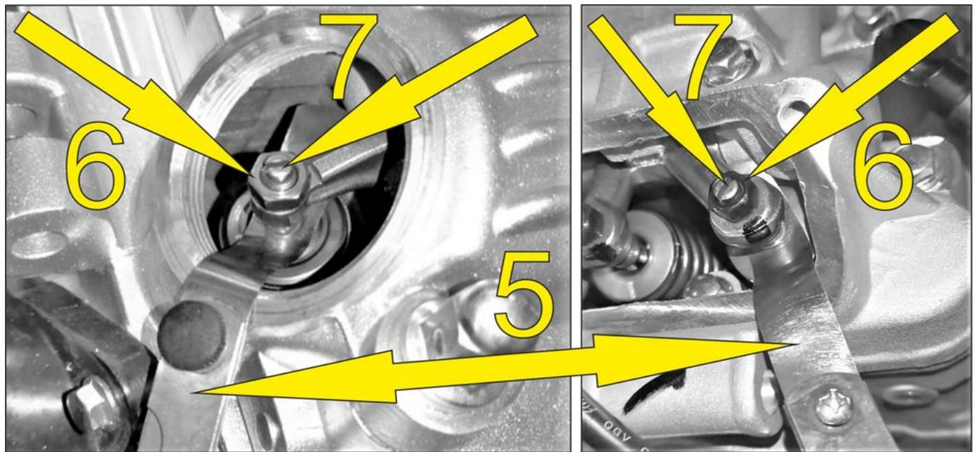
По окончании регулировки тепловых зазоров клапанов затяните контргайки [6] придерживая прямой отверткой винты [7], извлеките щуп и проверьте зазоры еще раз.
